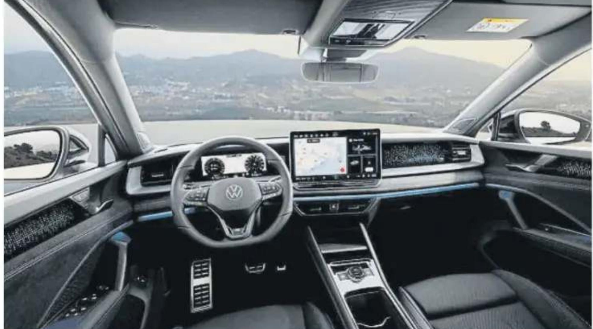
**Los cristales acústicos de 4,96 mm de grosor reducen hasta en 5 db el ruido en la cabina**
